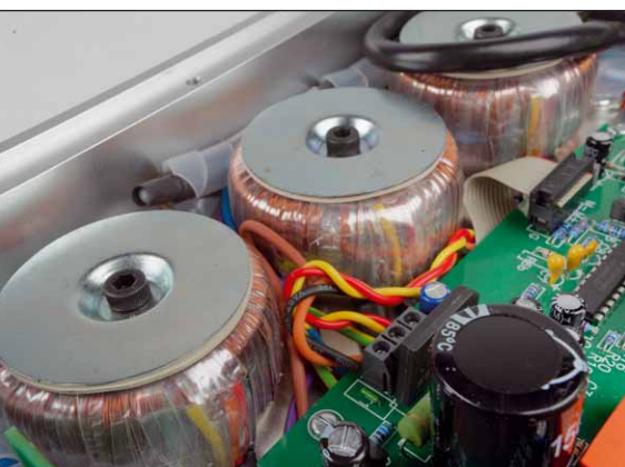
Gleich drei Trafos sitzen im EAS, von denen jeder jeweils eines der Boards, Streamer, DAC und Vorstufe, mit Spannung versorgt
